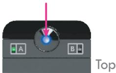
Ein Kanalwechsel funktioniert nur beim Sender (TX). Kurzes drücken der Kanalwechsel Taste schaltet zum nächsten HF-Kanal.
